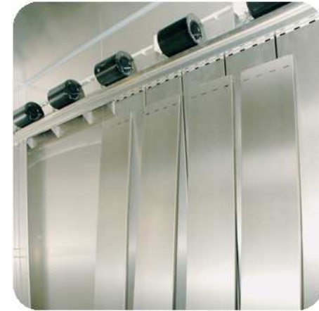
Turbinas para una distribución del aire más homogénea en toda la cámara
