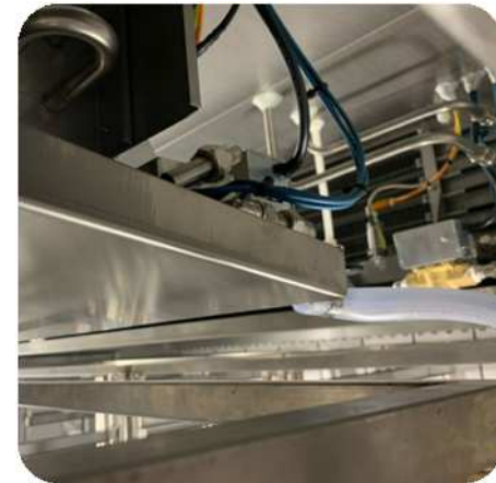
Bandeja de acero inoxidable plegable para un mejor mantenimiento
